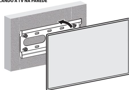
Com as hastes verticais travadas na traseira do televisor, encaixe os ganchos presentes na parte superior das hastes (3.1) e puxe as tiras das hastes para baixo (3.2), para permitir que a trava encaixe por trás da aba do suporte fixado na parede. Antes de soltar totalmente o televisor, certifique-se de que todo o conjunto está firme e travado (3.3).
