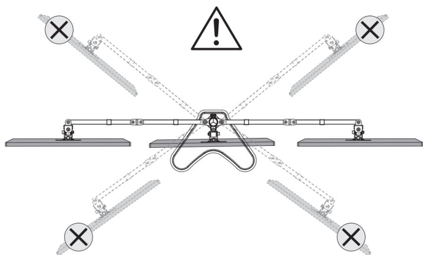
**9** Se necessário, alinhe os monitores através da regulagem dos parafusos de ajustes fino, localizados nas articulações de fixação dos monitores, conforme ilustração abaixo.
