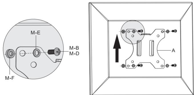
**5** Com as bases (A) firmemente instaladas nas traseiras dos monitores, encaixe-as nos conjuntos de articulações do suporte.
