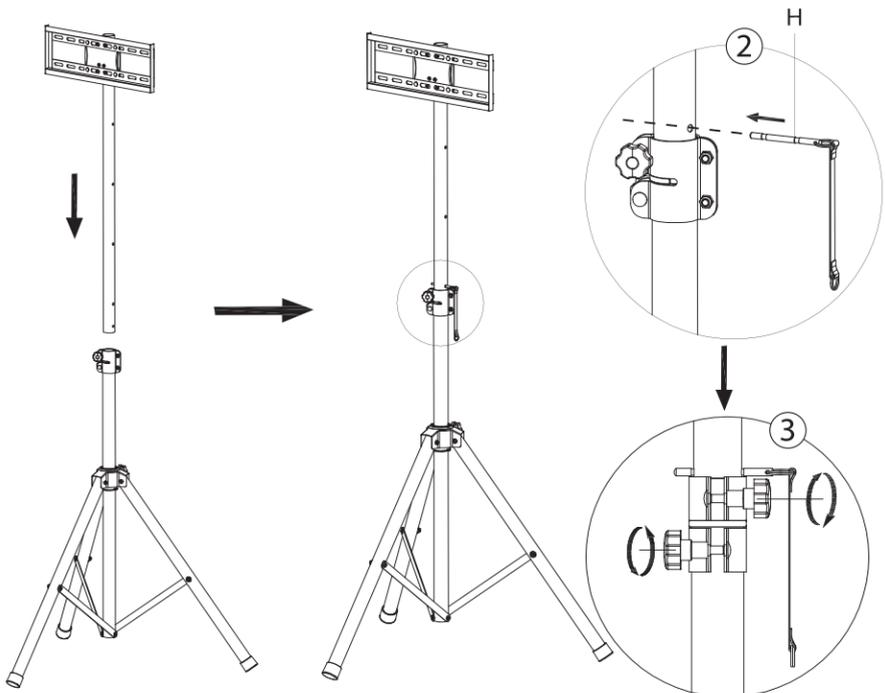
4 Identifique no kit de acessórios fornecido, qual parafuso é compatível com a rosca presente na traseira do televisor e trave as hastas verticais conforme figura abaixo. Os espaçadores plásticos podem ser utilizados entre as hastas e a face traseira do televisor ou entre a cabeça do parafuso e a haste, se for necessário compensar o comprimento do parafuso.
