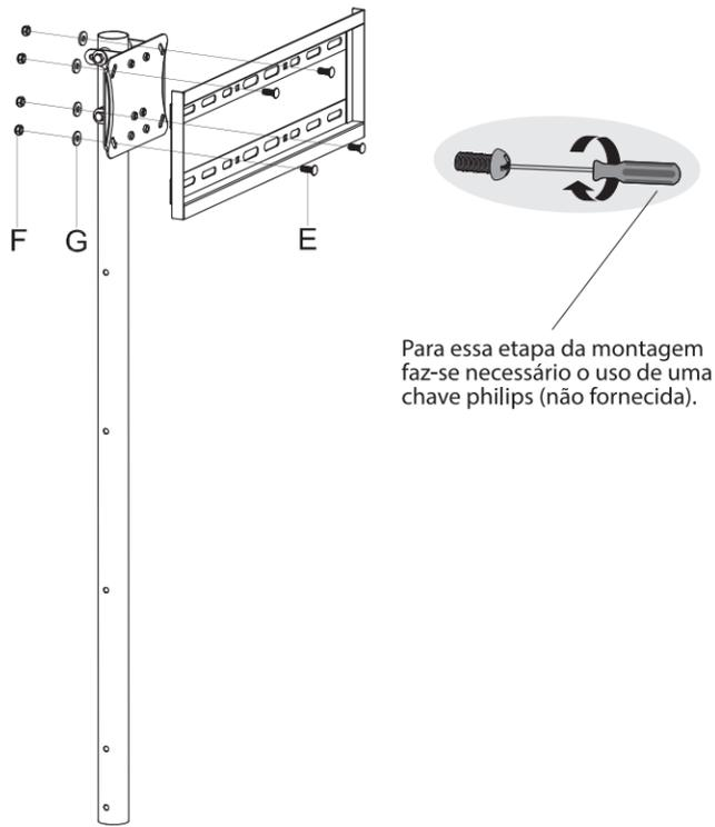
3 Regule a altura desejada, deslizando verticalmente o tubo interno do conjunto, encaixe o pino trava conforme indicado no detalhe 2 e trave o conjunto através do manípulo indicado no detalhe 3.
