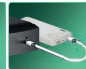
Energização de emergência (entrada Micro USB)
